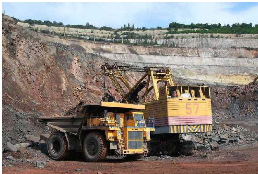
Рис. 4.8. Погрузка горной массы в автомобили БелАЗ (СГОК)
